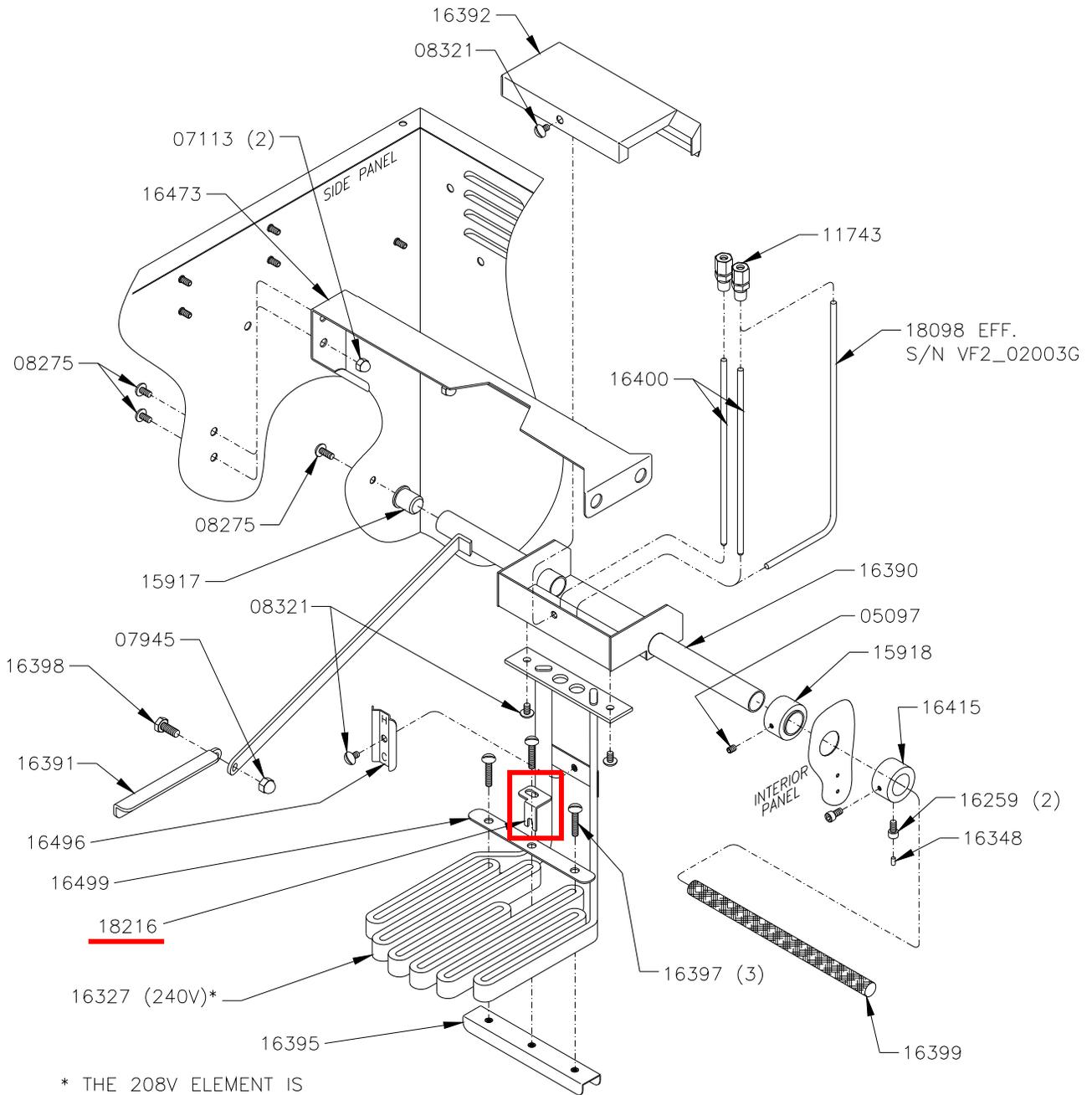
\* THE 208V ELEMENT IS NO LONGER AVAILABLE. USE THE 240V HEATING ELEMENT
